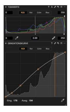
Die Gradationskurve moduliert die Ausgabetonwerte des Tonwerte-Werkzeugs – in unserem Beispiel mit der Voreinstellung »Contrast«, also mit erhöhtem Kontrast.
